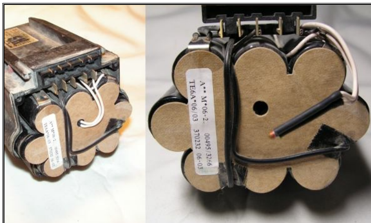
Thermistance en place / sortie de son logement
