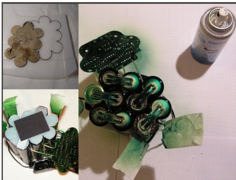
Protection par vernissage et remplacement de l'isolant en carton
