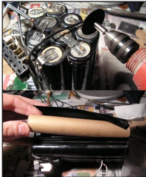
Tronçonnage d'une languette et extraction d'un bâton
